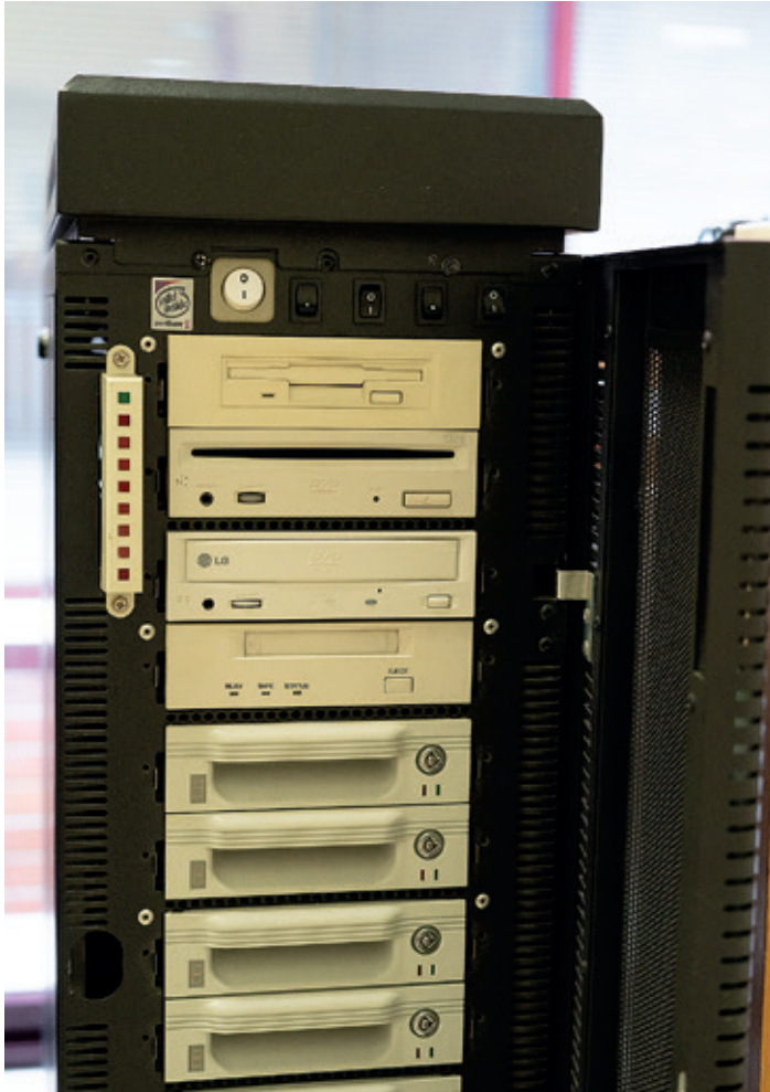
Figura 2. Torre de discos duros, ya en desuso, desde la que se distribuían bases de datos a la red unican. © EUC por G. R.
