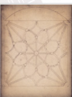
Figura de 1601. Diseño de plano cuadrado para un templo octogonal para de gable y de cinco niveles (I.P.P.A.J., Jaime Ordoz, 1443 v. 28 v.)
